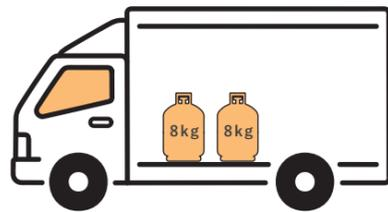
一般車両での積載移動は8キロボンベ2本まで運搬可能
